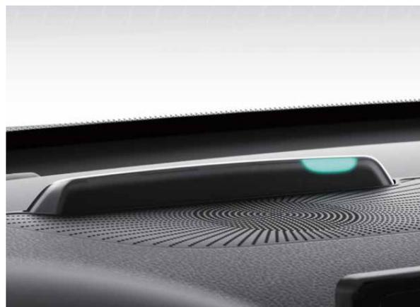
**Ladeanzeige.** Mit der Ladestandsanzeige behalten Sie den Ladezustand Ihrer Batterie immer im Blick. Sie befindet sich in der Mitte auf dem Armaturenbrett (wo sie auch von ausserhalb des Fahrzeugs leicht einsehbar ist) und hat drei LED-Leuchten, die beim Einstecken des Ladesteckers aktiviert werden und Sie über den Ladestatus und Batteriestand informieren.
