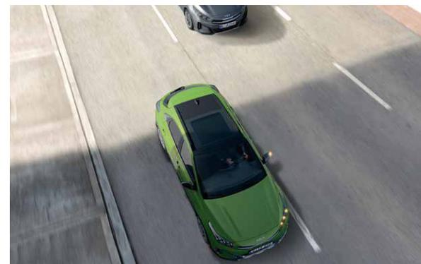
**Totwinkelassistent (Blind-Spot Collision-Avoidance Assist, BCA).** Eine weitere innovative Fahrerassistenztechnologie, die Ihre Fahrt sicherer und stressfreier macht, ist der Totwinkelassistent. Das System nutzt eine Frontkamera und Radarsensoren am Heck, um sich annähernde Fahrzeuge im toten Winkel zu erkennen und Sie mit einem Symbol im Aussenspiegel zu warnen.
