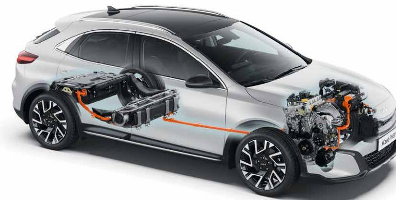
**Smarte Technologie.** Durch Betätigen der EV-/HEV-Taste auf der Mittelkonsole können Sie zwischen Elektro- und Hybridantrieb umschalten. Im EV-Modus - ideal für Fahrten im Stadtverkehr - nutzt der XCeed Plug-in Hybrid vorwiegend elektrische Energie und fährt somit nahezu emissionsfrei.\* Im HEV-Modus werden je nach Fahrsituation sowohl der Benzin- als auch der Elektromotor für den Antrieb genutzt, entweder jeweils allein oder gemeinsam.
