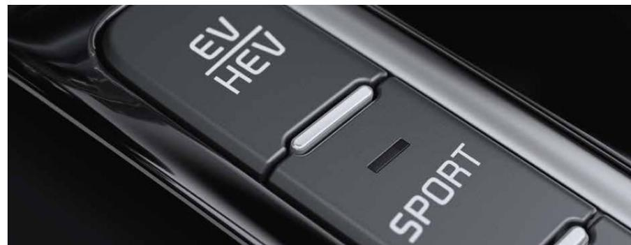
**HEV-/EV-Taste** (nur PHEV). Durch Betätigen der HEV-/EV-Taste auf der Mittelkonsole können Sie zwischen Elektro- und Hybridantrieb umschalten. Im EV-Modus - ideal für Fahrten im Stadtverkehr - nutzt das Fahrzeug vorwiegend elektrische Energie und reduziert damit die CO<sub>2</sub>-Emissionen gegen null. Im HEV-Modus werden sowohl der Benzin- als auch der Elektromotor für den Antrieb genutzt, entweder jeweils allein oder gemeinsam.
